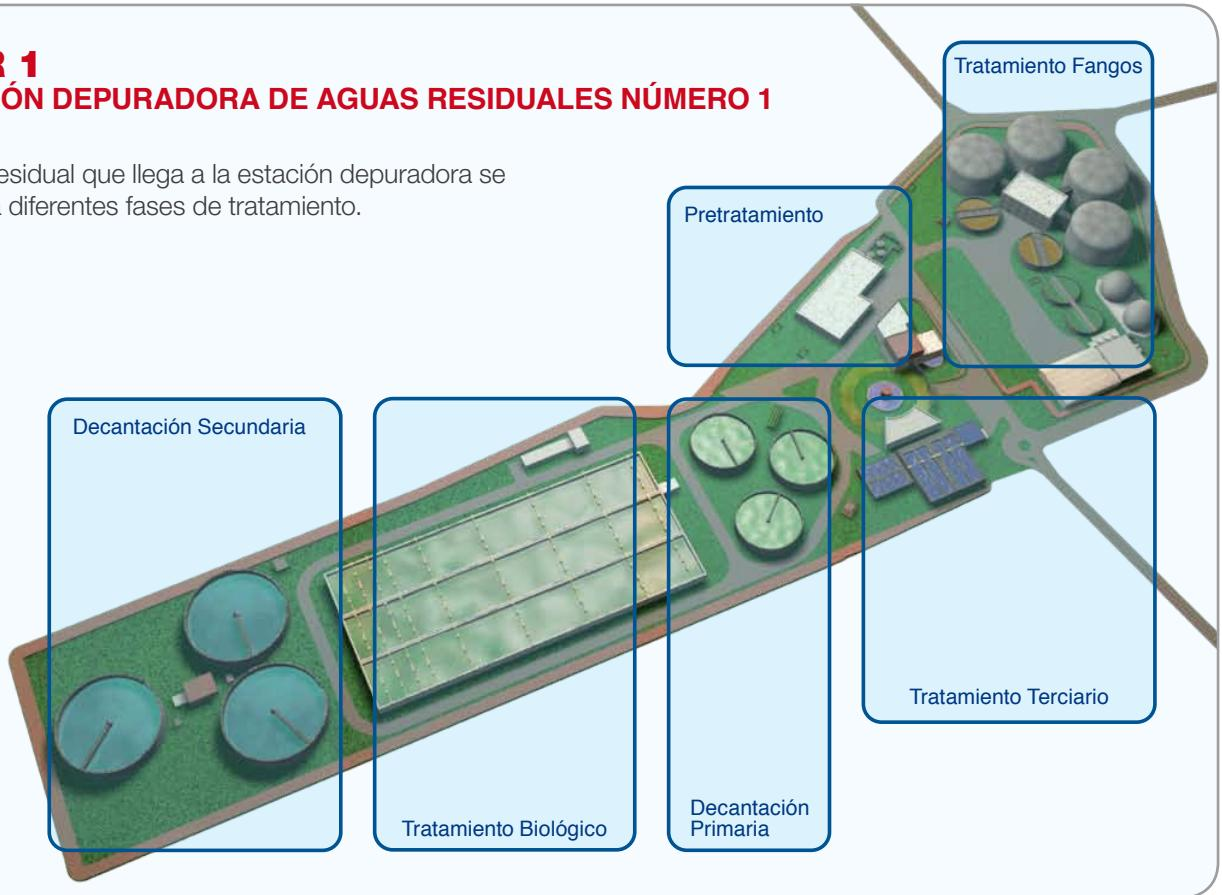
**PRETRATAMIENTO:** El agua sucia es tratada para la separación de los residuos sólidos con los que se encuentra mezclada. A partir de aquí pasan a tres canales aireados dónde se desprenden del agua.
